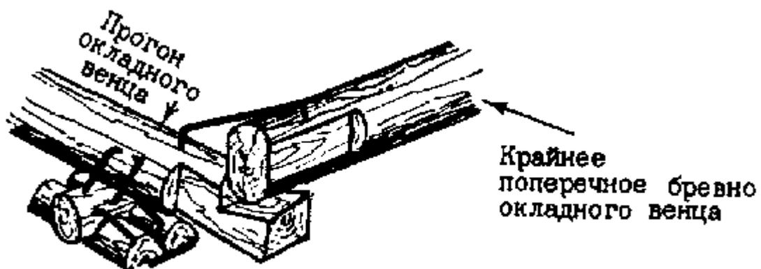
Причерчивание - это параллельный перенос точек линий сопряжения нижнего бревна на верхнее. Раствор черты при причерчивании "лапы" окладного венца выбирается минимальным, но таким, чтобы линия "лапы" поперечного бревна не попала на обзол.
