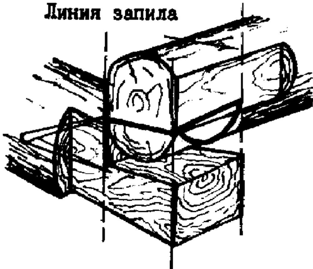
В процессе причерчивания бревна раствор черты менять нельзя! Проведём линии запила сверху вниз, разметим верх "лапы", а затем вырубим её. Сделаем на прогонах средний "болван".
