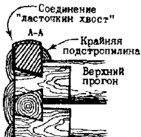
Заготовим брёвна для подстропилин длиной 7 м. Все их, кроме одного, следует отесать на два параллельных канта, получив шпалы одинаковой толщины (минимум 15 см). Врежем необработанную крайнюю подстропильную "ласточкиным хвостом" в прогон так, чтобы верх её был горизонтален.
