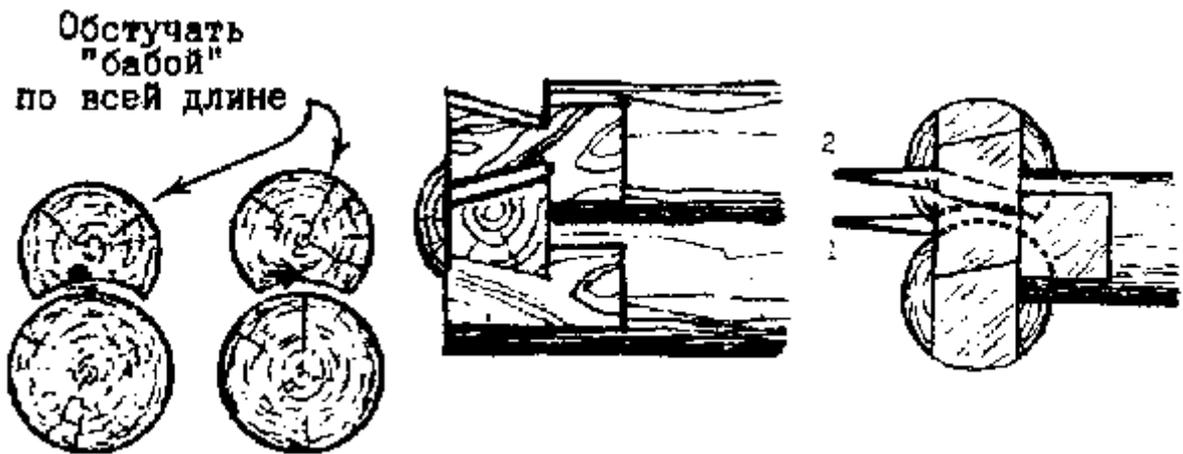
Следует сказать, что допустимы следующие размеры зазоров: в "лапе" - 0,5 см, в пазе - 1,5 см.
