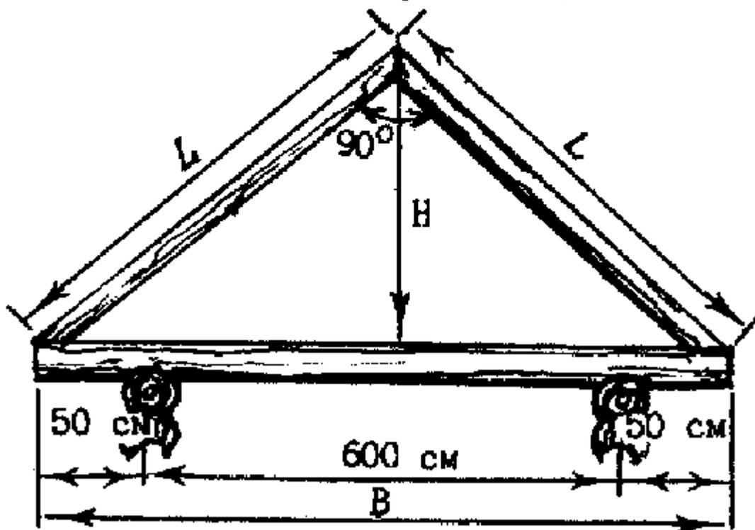
Подготовленные заготовки стропил необходимо разобрать парами и пронумеровать. На заготовках стропил та сторона, на которую будет крепиться обрешётка, должна быть ровной, без выступающих сучков.
