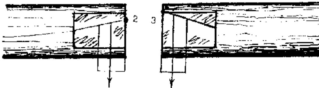
На щёках бревна проводим вертикальные линии, отстоящие от торца на ширину "болвана" ответного бревна, и получаем точки 4 и 5. Делаем вертикальный запил до линии 4-5.
