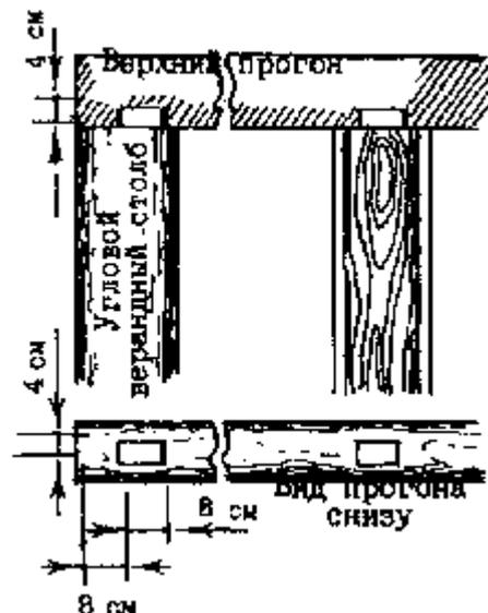
Перенесём на поперечные брёвна линии внутренних щёк прогонов. Откатив прогон, вырубим на крайнем поперечном бревне "лапу", а на среднем - "ласточкин хвост". Сделаем щёки в верхних прогонах соответственно "ласточкиному хвосту" поперечного бревна. На нижней стороне прогонов изготовим лузы глубиной 4 см под шипы верандных столбов. Снова уложим прогоны и, причертив их, врежем в соответствующее место.
