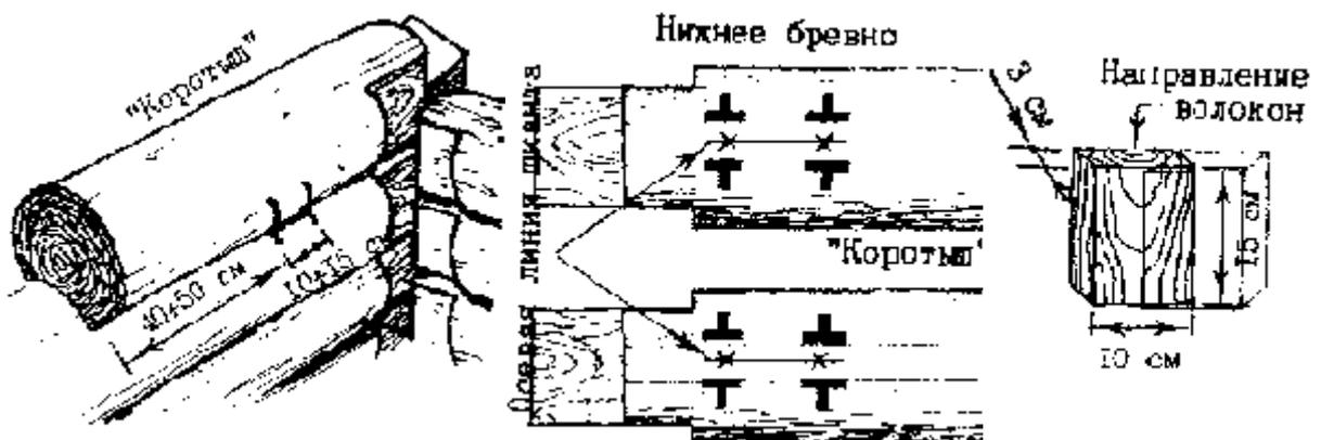
Для разметки осевых линий шканта на обоих брёвнах необходимо снять "коротыш" (бревно в разрезном венце). Затем по осевой линии стамеской выбираются лузы под шкант. Суммарная глубина луз должна быть на 1 см больше высоты шканта. Шкант в лузу должен входить плотно.
