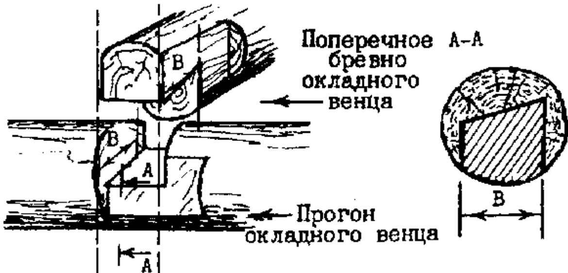
Теперь займёмся нижней обвязкой. Изготовим "болваны" на прогонах нижней обвязки, уложим их над прогонами окладного венца. Пользуясь подкладками и уровнем, необходимо добиться, чтобы верхние части прогонов были горизонтальны и лежали в одной плоскости с точностью ~3 см. Следует учитывать, что комли и вершины в венцах чередуются. Закрепим прогоны скобами.
