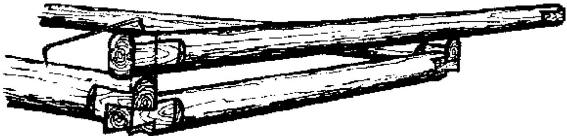
Проверим и откорректируем размеры А-В, С-Д. Используя подкладки и скобы, добьемся горизонтальности верха прогонов.
