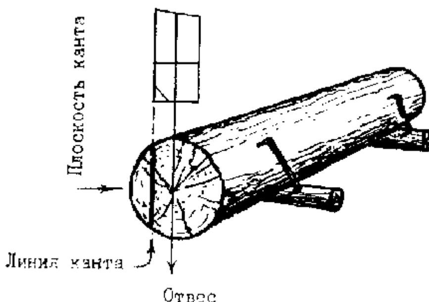
Закрепляем шнур при помощи шил в плоскости канта. Затем производим визуальную проверку, глядя с торца бревна, и корректируем положение шнура. Цветным карандашом переносим проекцию шнура на бревно. Для получения второй линии канта повторим те же операции, перевернув бревно.
