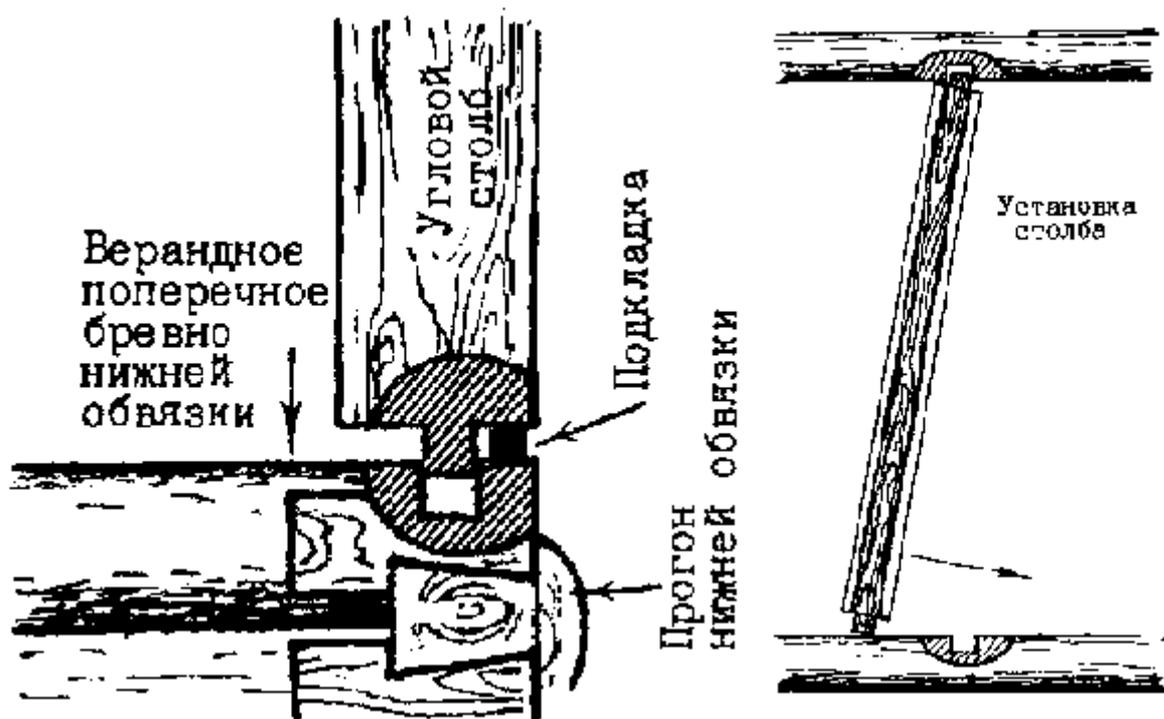
Установив угловые столбы, уложим на место верандные подстропилы и закрепим их скобами. Остальные столбы нужно изготавливать и устанавливать после усадки сруба. Дверные и оконные столбы, также как и угловые, обрабатываются на три
