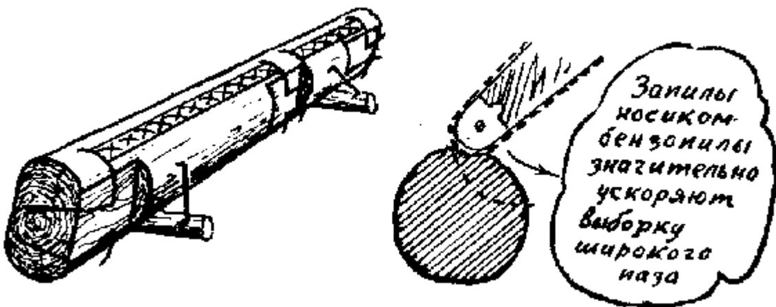
После этого следует вырубить "лапы" и, уложив бревно на место, проверить плотность его прилегания. Для этого укладываемое бревно должно лежать на внутренних щеках с небольшим свесом. При опрокидывании оно легко ляжет на
