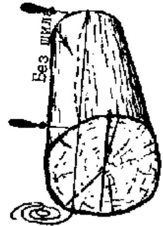
После этого скобами закрепляем бревно для тёски, но не сильно, дабы не пришлось потом выбивать их при помощи лома. Расположим плоскость будущего канта вертикально, сделаем надруб и, отесав бревно, получим кант.
