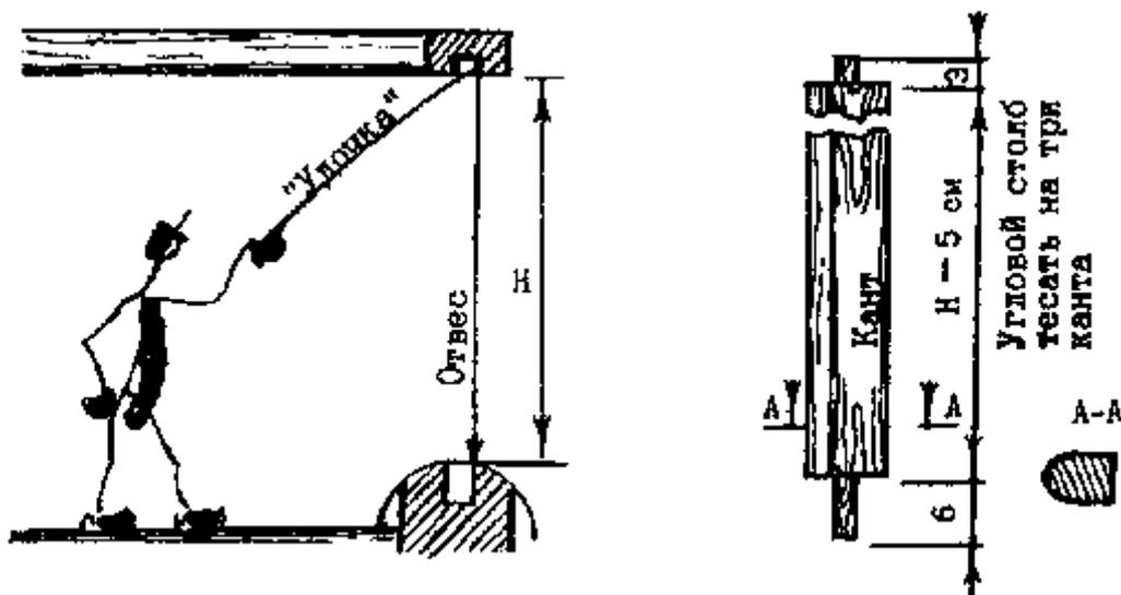
Угловые столбы необходимо обработать на три канта, причем расстояние между двумя параллельными кантами должно составлять минимально 16 см. Далее следует вырезать столб в размер.
